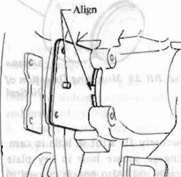
Fig. BR-23 Installing Pads
